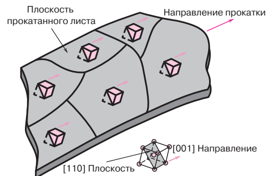
Рис. 18.21. Схема, представляющая собой листовую текстуру (110)[001] , образующуюся при прокате железа с объемно-центрированной кубической решеткой
