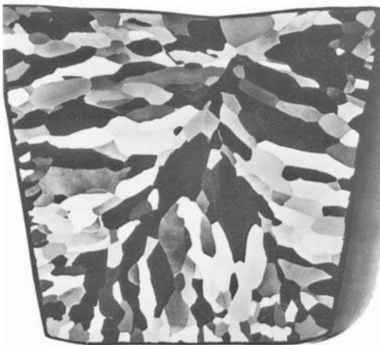
Рис. 5.17. Свинцовая поликристаллическая чушка высокой чистоты, в которой можно увидеть отдельные зерна \times 0,7 (воспроизведено с разрешения из Metals Handbook . Vol. 9, 9 th edition. Metallography and Microstructures , American Society for Metals, Metals Park, OH, 1985)
