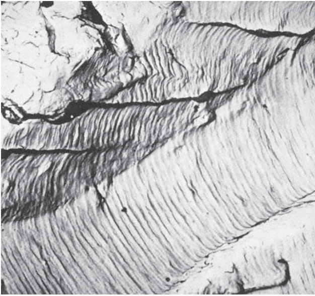
Рис. 9.29. Электронная микрофотография, полученная «на просвет», на которой видны бороздки, образовавшиеся при усталостном разрушении алюминия. Увеличение не известно (заимствовано из V.J. Colangelo and F.A. Heiser, Analysis of Metallurgical Failures , 2 nd Edition, John Wiley & Sons, New York.)
