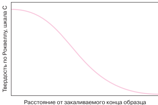
Рис. 14.6. Типичная кривая восприимчивости к упрочнению, представляющая собой зависимость твердости по Роквеллу, шкала С от расстояния до охлаждаемого конца образца
