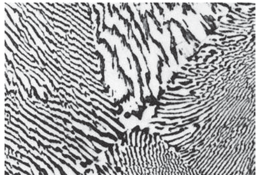
Рис. 10.14. Микрофотография, иллюстрирующая микроструктуру сплава свинец–олово эвтектического состава. Как видно из снимка, структура характеризуется чередующимися слоями обогащенной свинцом твердой \alpha -фазы (темные полосы) и слоями обогащенной оловом \beta -фазы (светлые полосы). Увеличение \times 375 (воспроизведено с разрешения Metals Handbook, 9th edition. Vol. 9, Metallography and Microstructures. American Society for Metals, Materials Park, OH, 1985 )
