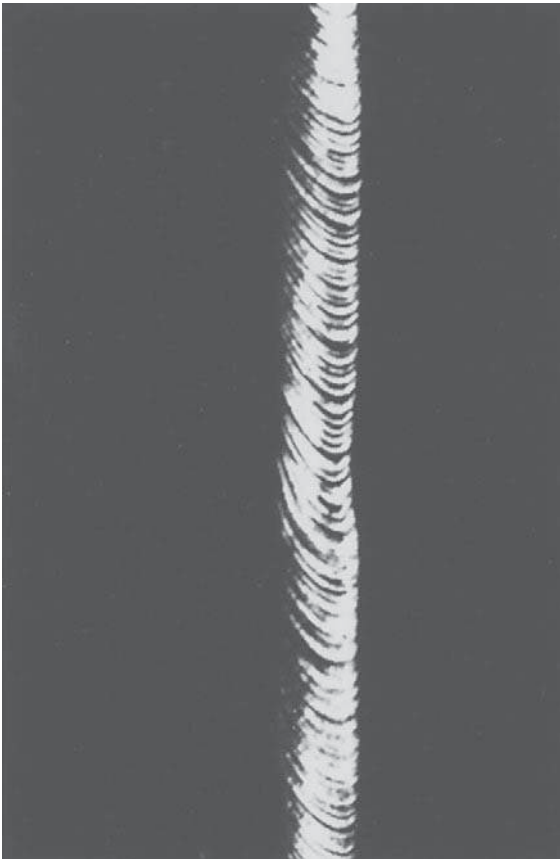
Рис. 8.9. Скольжение в единичном кристалле цинка (заимствовано из C.F. Elam, The Distortion of metal Crystals, Oxford University Press, London, 1935. )
