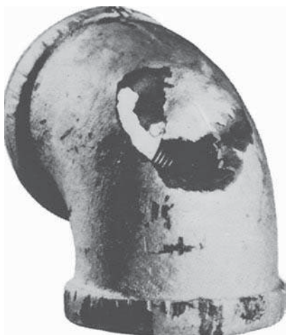
Рис. 16.20. Разрушение фитинга, установленного на конденсатной линии паровой установки, вследствие эрозионной коррозии. (Фотография предоставлена Mars G. Fontana ; Заимствовано из M.G. Fontana, Corrosion Engineering, 3 rd edition, 1986, McGraw-Hill Book Company. )
