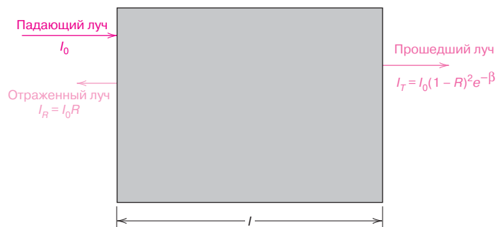
Рис. 19.7. Прохождение света через прозрачную среду, при наличии отражения от передней и задней стенок и поглощения в объеме среды. (Заимствовано из R.M. Rose, L.A. Shepard, and J. Wulff, The Structure and Properties of Materials, Vol. IV, Electronic Properties , 1966, John Wiley & Sons, New York.)
